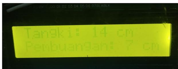
Gambar 5. Pengukuran Ketinggian Air Tanki dan Pembuangan
