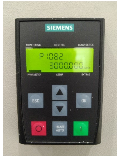
Gambar 2. Putaran Maksimum Motor 3000 Rpm pada BOP inverter
