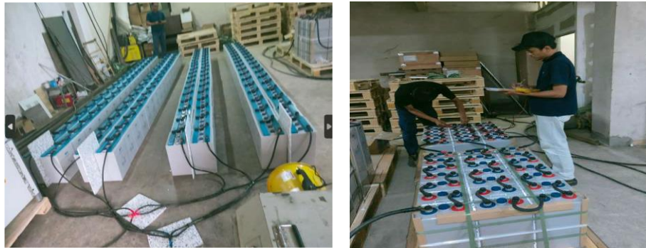
Gambar 4. Proses Pengujian Kapasitas Baterai
