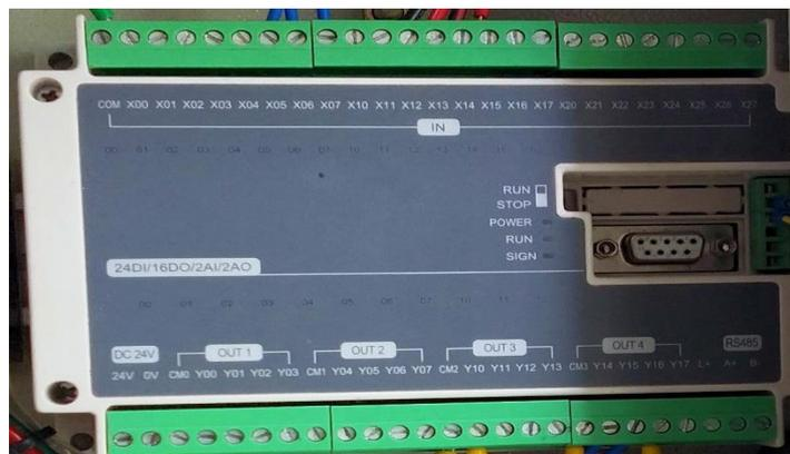
Diagram Ladder merupakan bahasa pemrograman populer untuk PLC. Namun, bahasa pemrograman alternatif yang dapat digunakan untuk memprogram PLC antara lain Function Block Diagram (FBD), Instruction List (IL), Structure Text (ST), Sequential Function Chart (SFC), dan Statement List (SL)[19]. Diagram Ladder mensimulasikan logika yang diterapkan langsung oleh relai. Diagram Ladder membantu teknisi mencapai tujuan mereka dengan mengurangi kompleksitas yang terlibat.[19].
