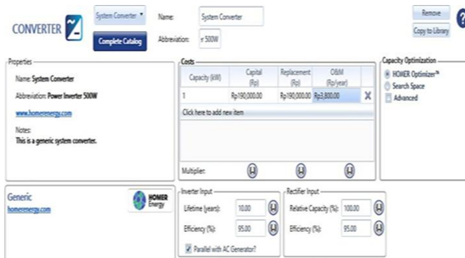
Gambar 6. Tampilan Pengaturan Inverter pada HOMER
