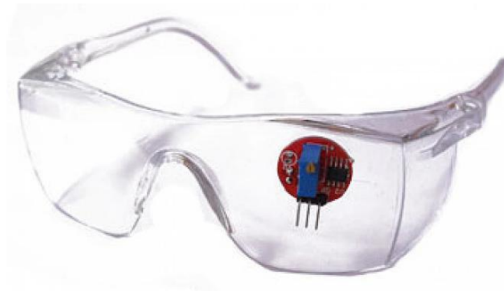
Gambar 4.2 Pemasangan sensor eye blink pada sebuah kaca mata percobaan
