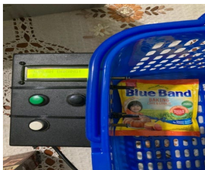
Gambar 4.2.3 LCD Menampilkan Jumlah barang sesuai dengan barang di trolley
