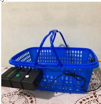
Gambar 4.1 Hasil Sistem Smart Trolley Menggunakan Sensor Jarak E18- D80NK
